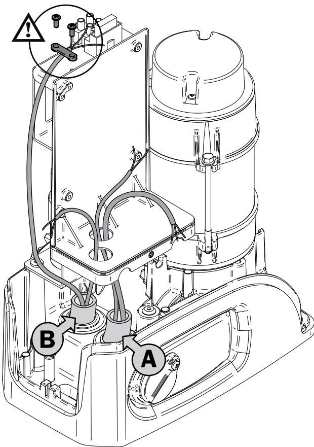
**B****Canalina per passaggio cavi alimentazione motore e centrale di comando**
